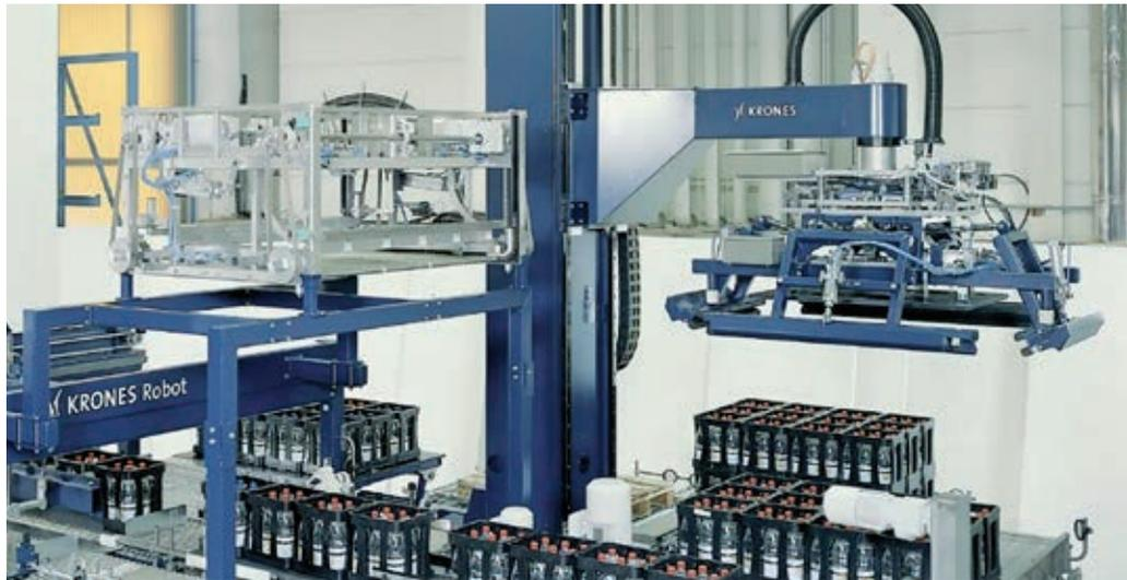
INA-Rollenumlaufeinheiten in einem Pack- und Palettierroboter: Damit sichert der Maschinenhersteller die Präzision seiner Anlagen auch bei höchsten Belastungen sowie Prozesssicherheit auf Dauer (Bild KRONES)
