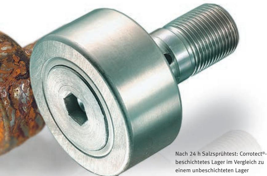
Nach 24 h Salzsprühstest: Corrotect®-beschichtetes Lager im Vergleich zu einem unbeschichteten Lager
