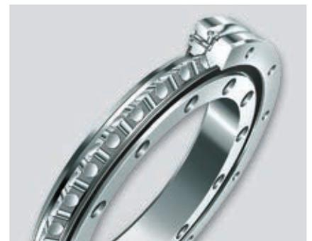
Spart eine Lagerstelle: INA-Kreuzrollenlager XSU nehmen radiale und axiale Belastungen, Kippmomente sowie beliebige Lastkombinationen auf
