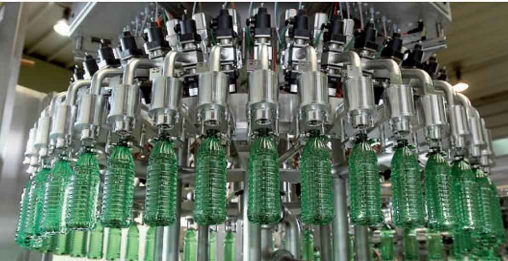
Unbedingte Zuverlässigkeit gefordert: Im Produktfüller für PET-Flaschen ist die Leistungsfähigkeit von Drehverbindungen gefragt (Bild KRONES)
