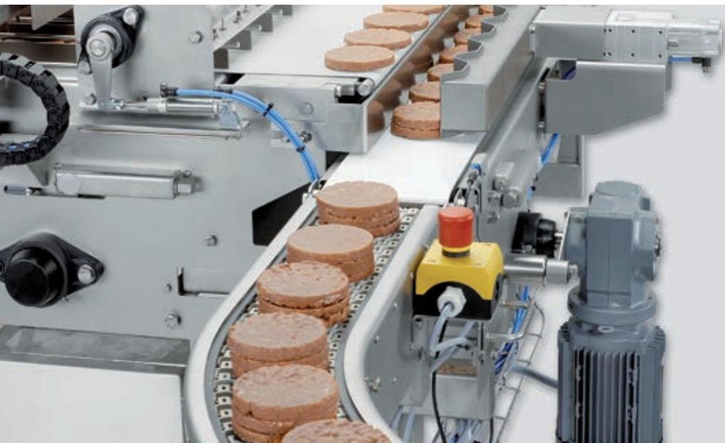
Lebensmittelgerecht und rostgeschützt: Kunststoff-Flanschgehäuse im Waffeltransportsystem (Bild TMF Belting Systems B.V.)
