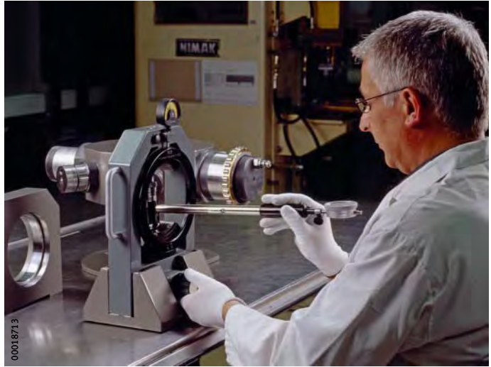
Bild 2 Laufbahndurchmesser auf das Hüllkreismessgerät übertragen
